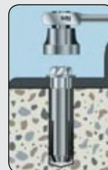
Затянуть болт или гайку с необходимым моментом
